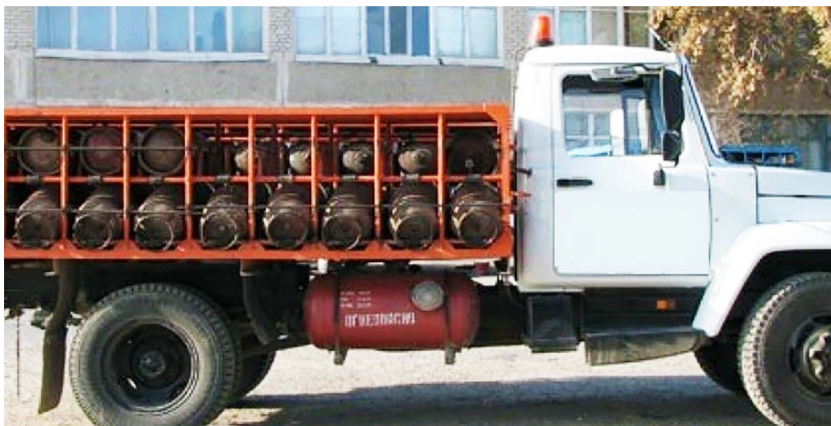
Рисунок 2 – Автомобиль для доставки баллонов с газом с двигателем на бензиновом и газовом топливе (пропанобутановая смесь)
