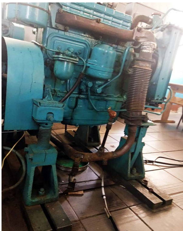
Рисунок 3 – Место установки трубки газоанализатора
