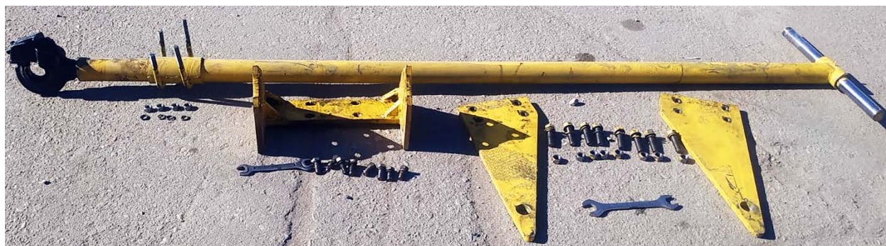
Рисунок 1 – Сборочные элементы буксирно-распределяющего устройства
