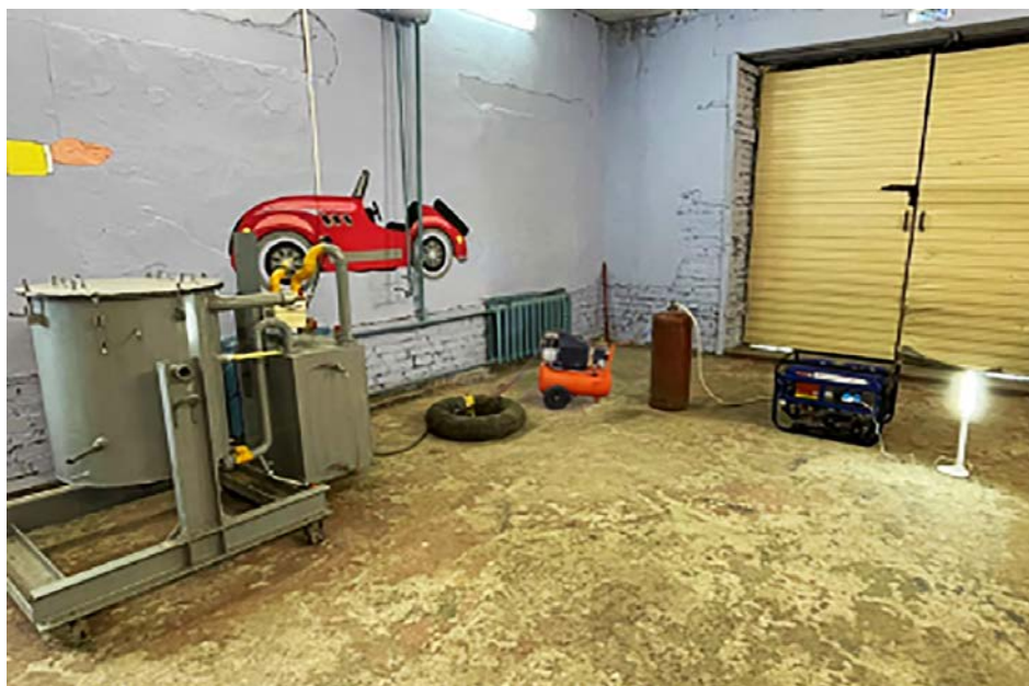
Рисунок 3 – Проверка автономной когенерационной линии на пиролизной технологии
