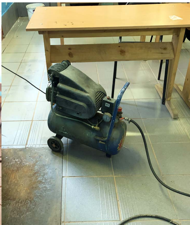
Рисунок 4 – Компрессор для подачи дополнительного воздуха
