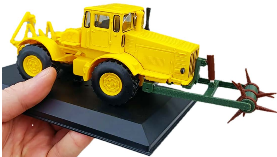
Рисунок 2 – Прототип прокалывателя-щелереза, изготовленного методом 3D-печати
