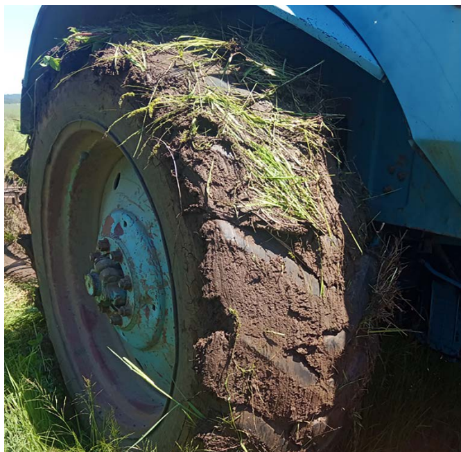
Рисунок 1 – Пример полного залипания протектора движителя трактора
