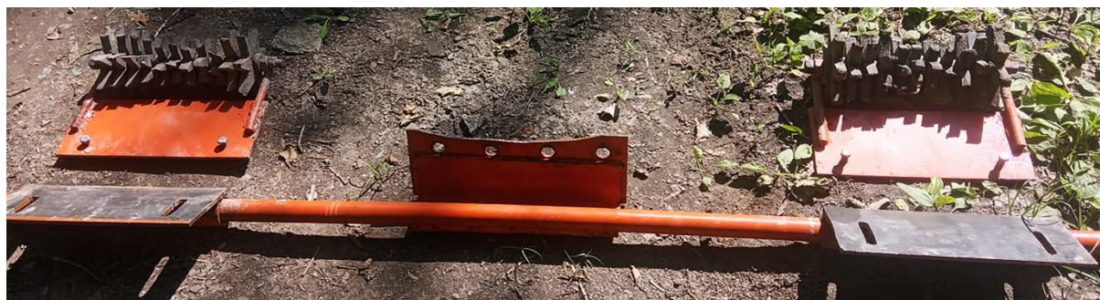
Рисунок 2 – Комбинированный очиститель протектора колесного движителя
