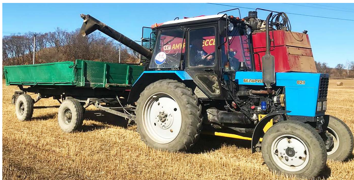
Рисунок 2 – Фрагмент проведения экспериментальных исследований (опытный агрегат с установленным буксирно-распределяющим устройством)
