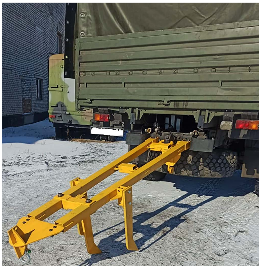
Рисунок 3 – Установка и проверка опытного устройства
