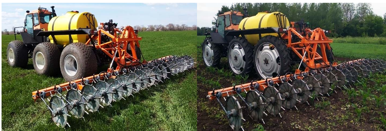
Рисунок 2 – Агрегат «Туман-2М» при внесении КАС
