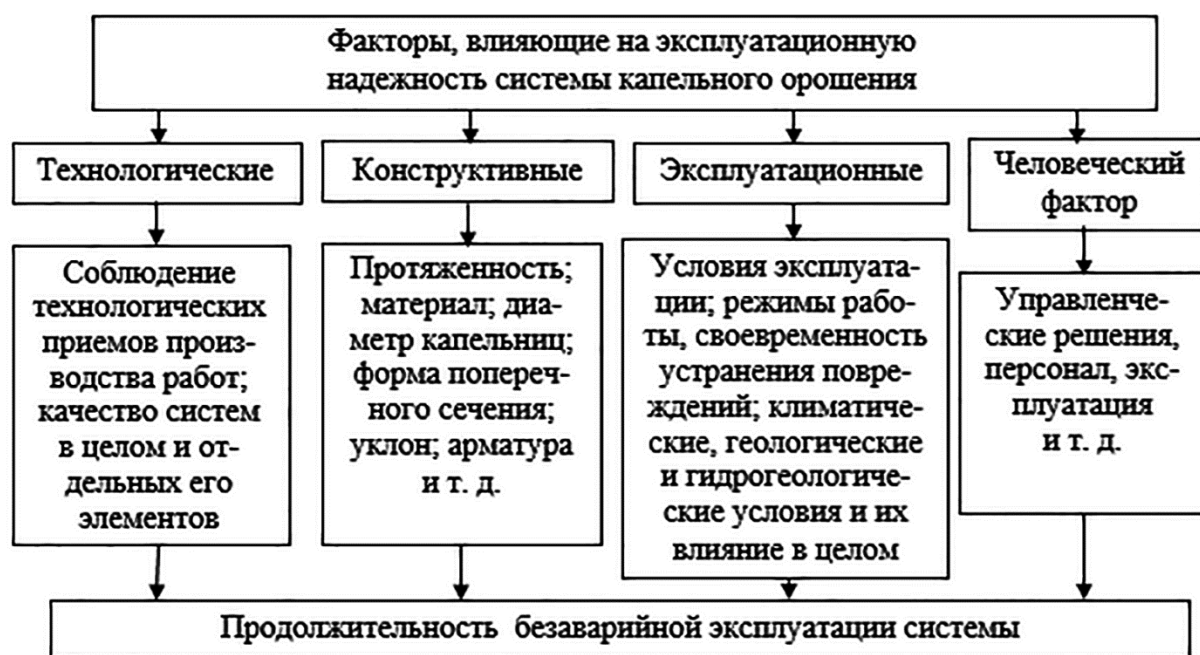
Рисунок 1 – Структурная схема факторов, влияющих на продолжительность безаварийной эксплуатации системы капельного орошения
