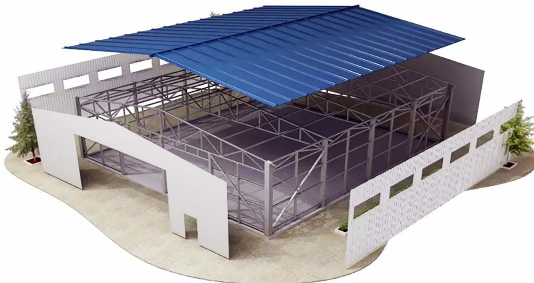
Рисунок 1 – Макет конструкции быстровозводимого здания
