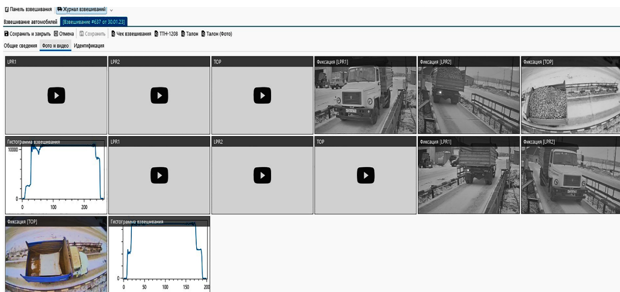
Рисунок 1 – Фото и видео фиксация бизнес-процесса «Взвешивание» в автоматическом режиме
